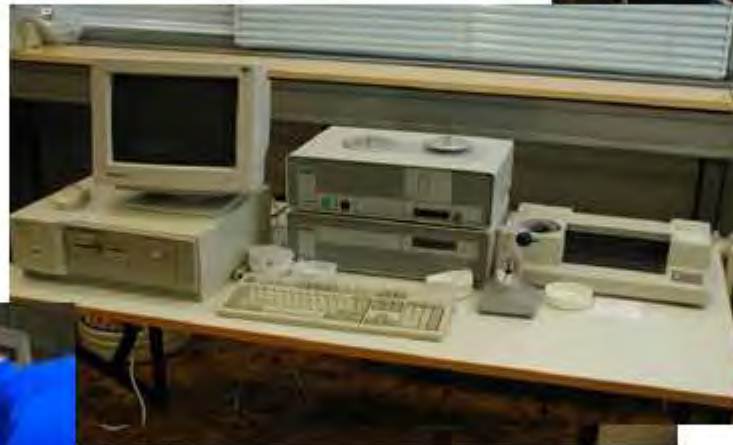
Differential Scanning Calorimeter (DSC) (-180 °C bis 600 °C)
