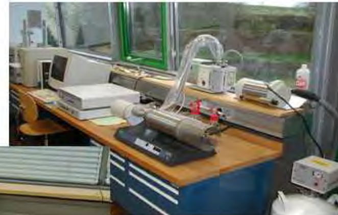
Dilatometer (-180 °C bis 1.600 °C)
