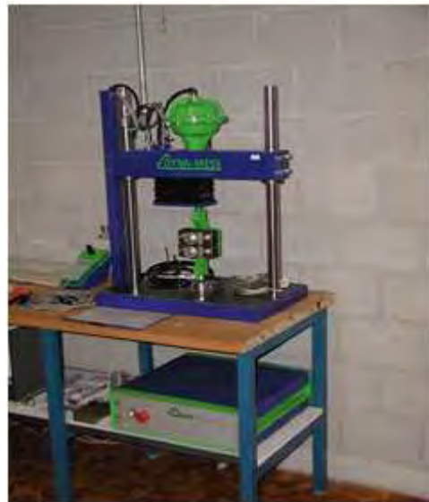
Schwingprüfmaschine (10 kN, 10 HZ)
