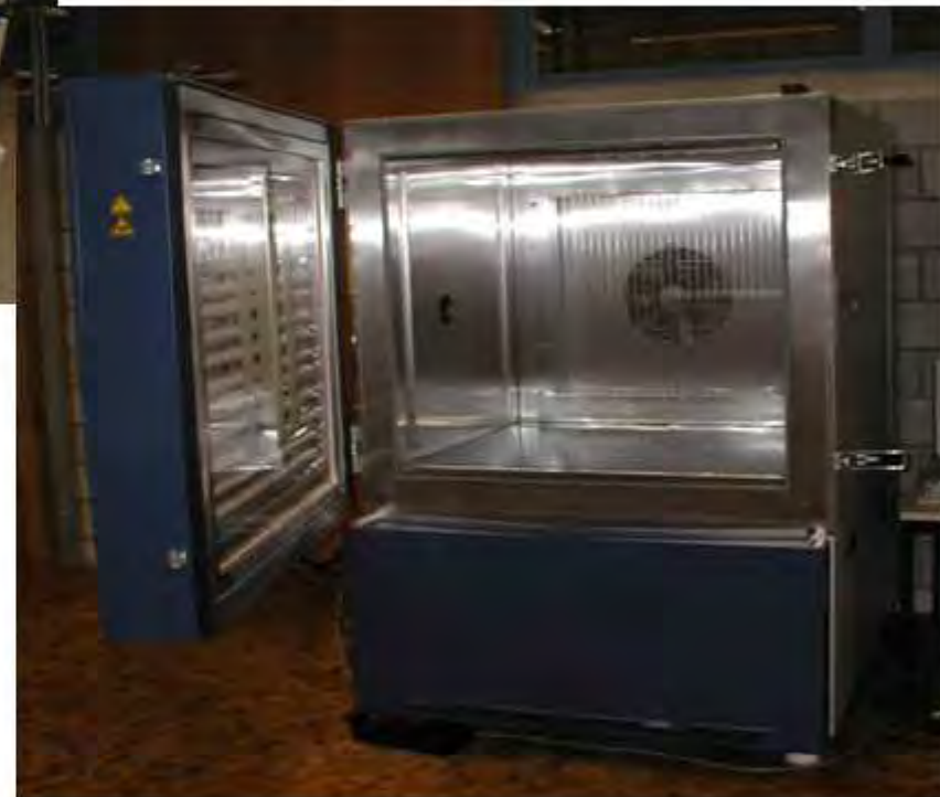
Klimakammer, (Luftfeuchte, Temp., UV-Strahlung)
