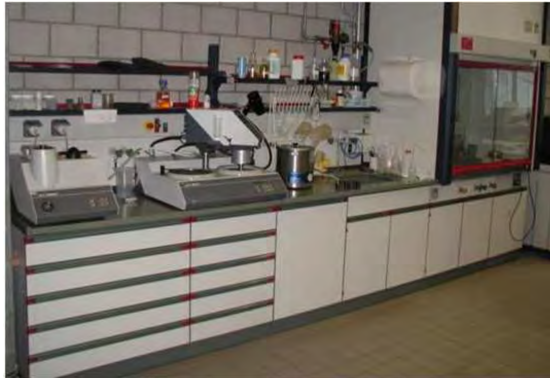
Einbetten – Schleifen – Polieren – Ätzen
